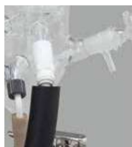
冷卻迴路使用 one-touch 快速接頭
