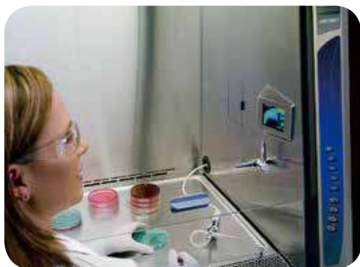
眼睛平視高度的LCD顯示面板及控制面板
