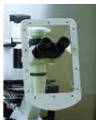
顯微鏡專用 抗UV玻璃拉門
